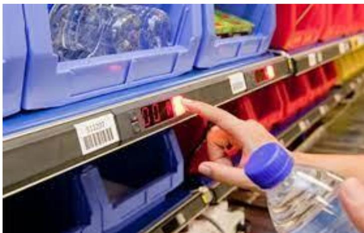
El sistema de *picking to light* se trata de un sistema de preparación de pedidos (picking) dotado de estanterías dinámicas y visores numéricos para ayudar al operario a saber dónde se encuentra exactamente el artículo que tiene que recoger y el número de unidades.
