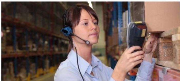
El **Voice Picking** le indica al encargado del acomodo qué pallet debe tomar de la zona de recibo; el operador lee o escanea el LPN (License Plate Number) impreso en el pallet para confirmar que va a almacenar la pieza correcta.
