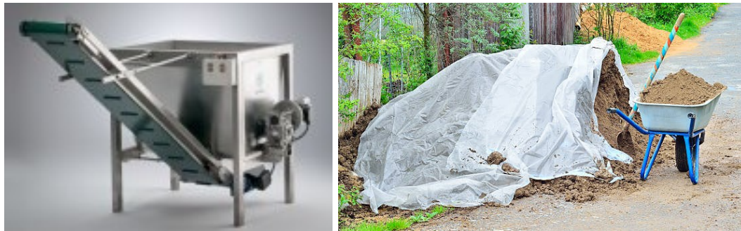
Mezcladora de sustratos profesional y acopio protegido bajo plástico en una obra de jardinería.
