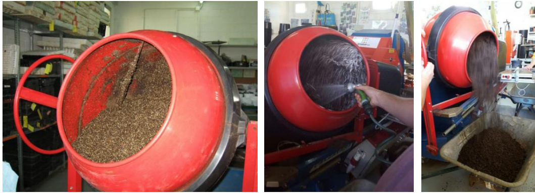
Fases del proceso de mezcla del sustrato realizado con la ayuda de una hormigonera.
