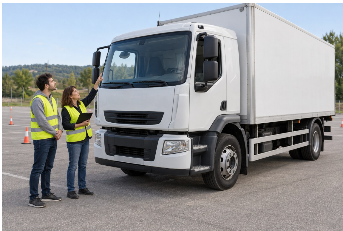
El reconocimiento exterior de un camión inmovilizado ayuda a relacionar los retrovisores con las zonas que deberá observar el alumno
