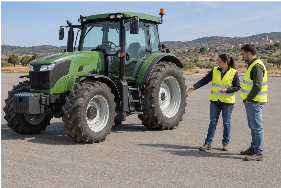
La explicación con el tractor inmovilizado permite reconocer el espacio ocupado por las ruedas y preparar la observación durante los giros
