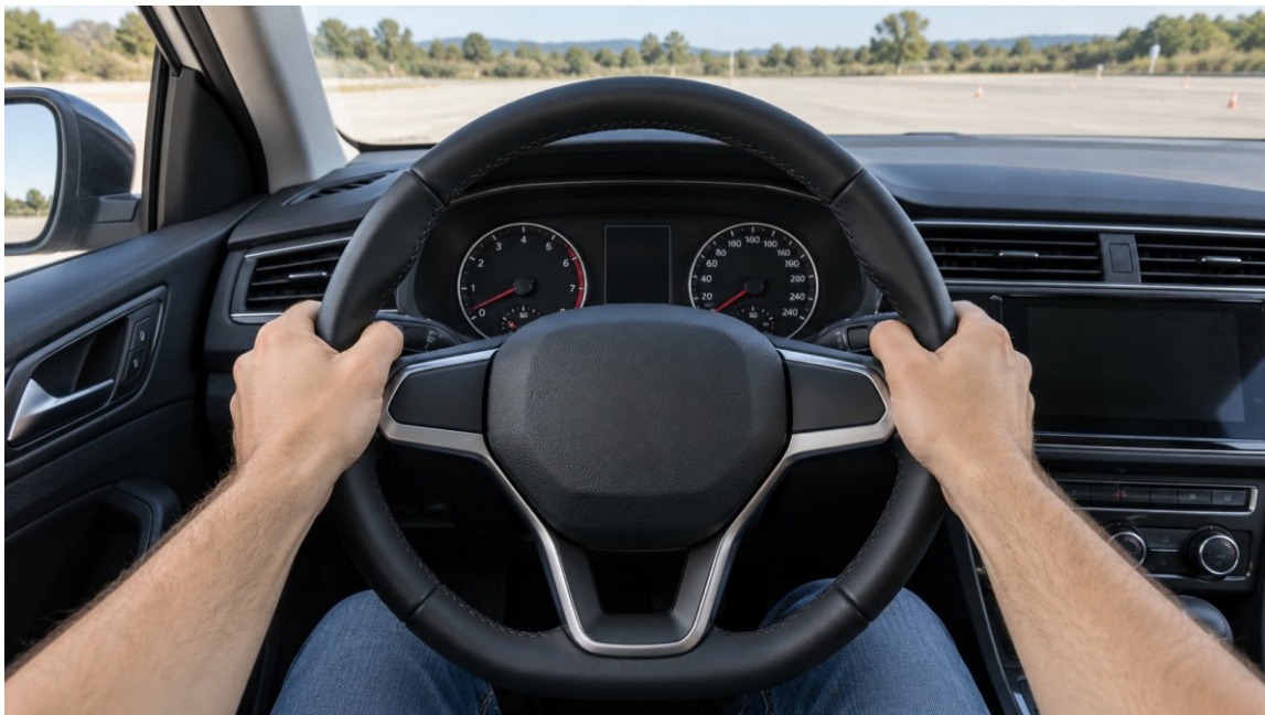
La sujeción lateral con ambas manos permite dosificar el giro y actuar hacia los dos lados
