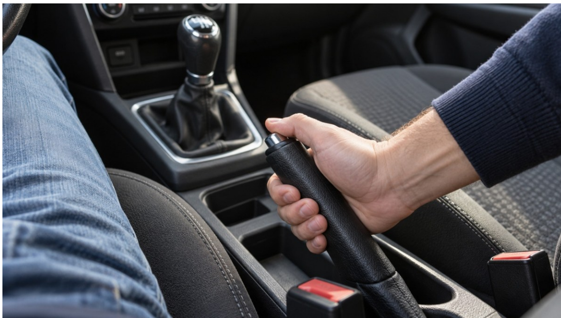
El freno de estacionamiento mecánico se aplica con el vehículo detenido y se comprueba antes de abandonar el puesto de conducción
