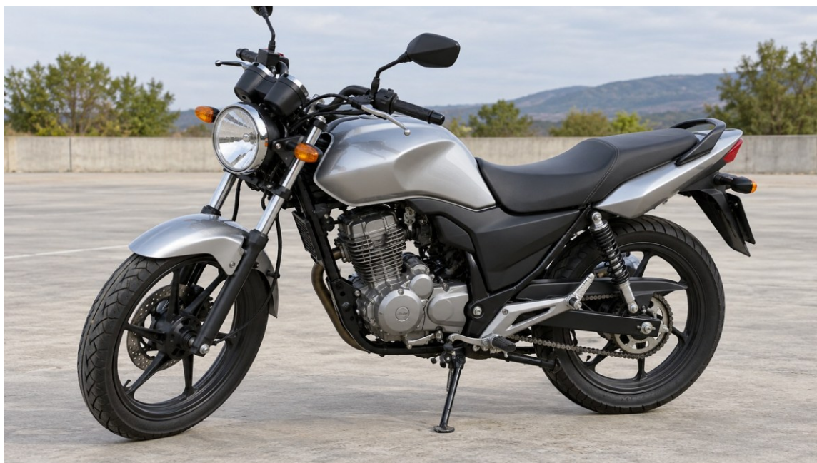
El caballete lateral necesita un despliegue completo y una superficie firme que no ceda bajo su pie
