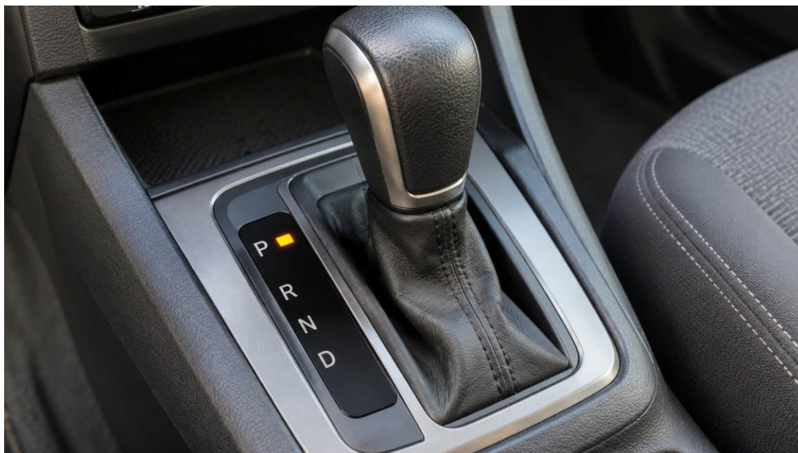
Las posiciones P, R, N y D identifican funciones distintas; la indicación seleccionada debe comprobarse antes de iniciar el movimiento.
