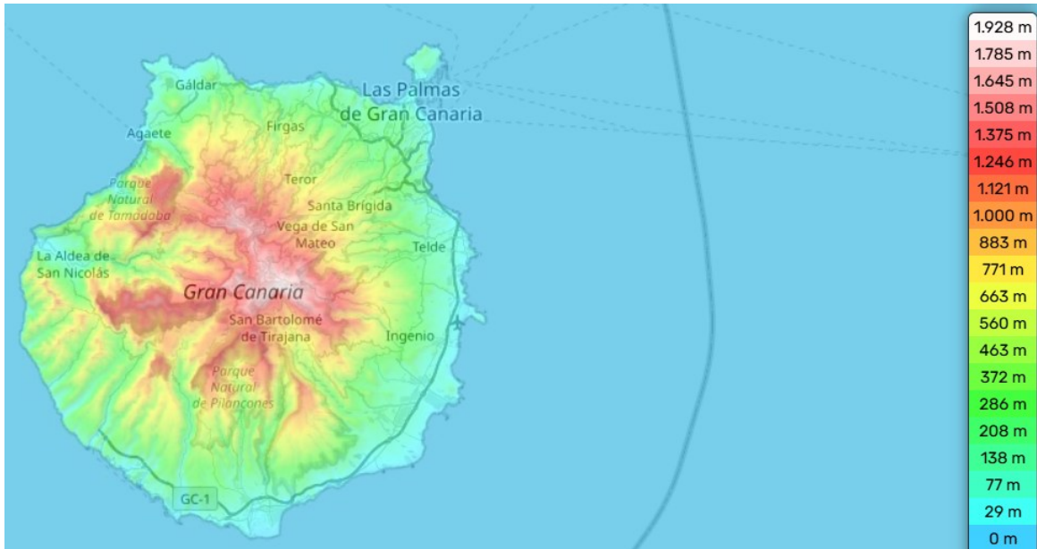
Mapa hipsométrico con leyenda graduada de altitudes, útil para interpretar el relieve mediante una escala cromática organizada y asociada a valores métricos.
