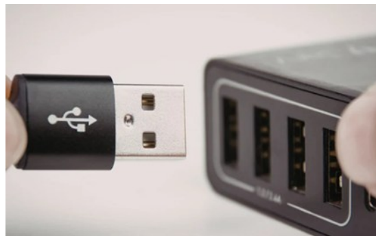
Concentrador USB utilizado para la conexión simultánea de varios dispositivos de entrada y salida a un único puerto del sistema informático
