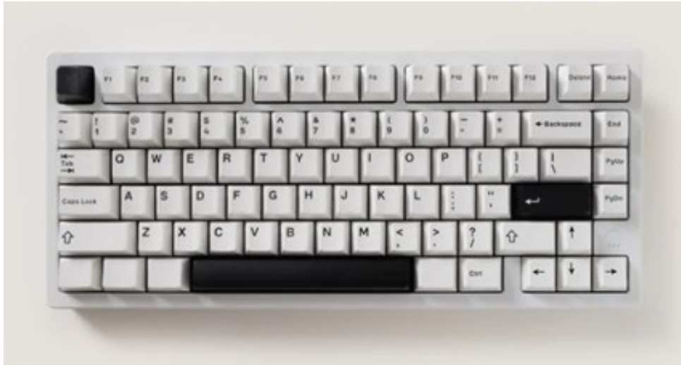
Teclado mecánico compacto, con interruptores individuales por tecla, caracterizado por un mayor recorrido, precisión y durabilidad frente a los teclados de membrana.
