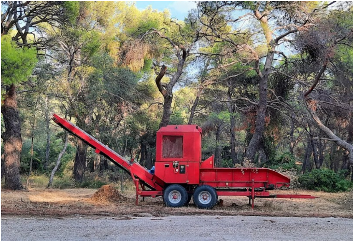
Trituradora de restos vegetales de gran capacidad, para ramas leñosas de gran tamaño.
